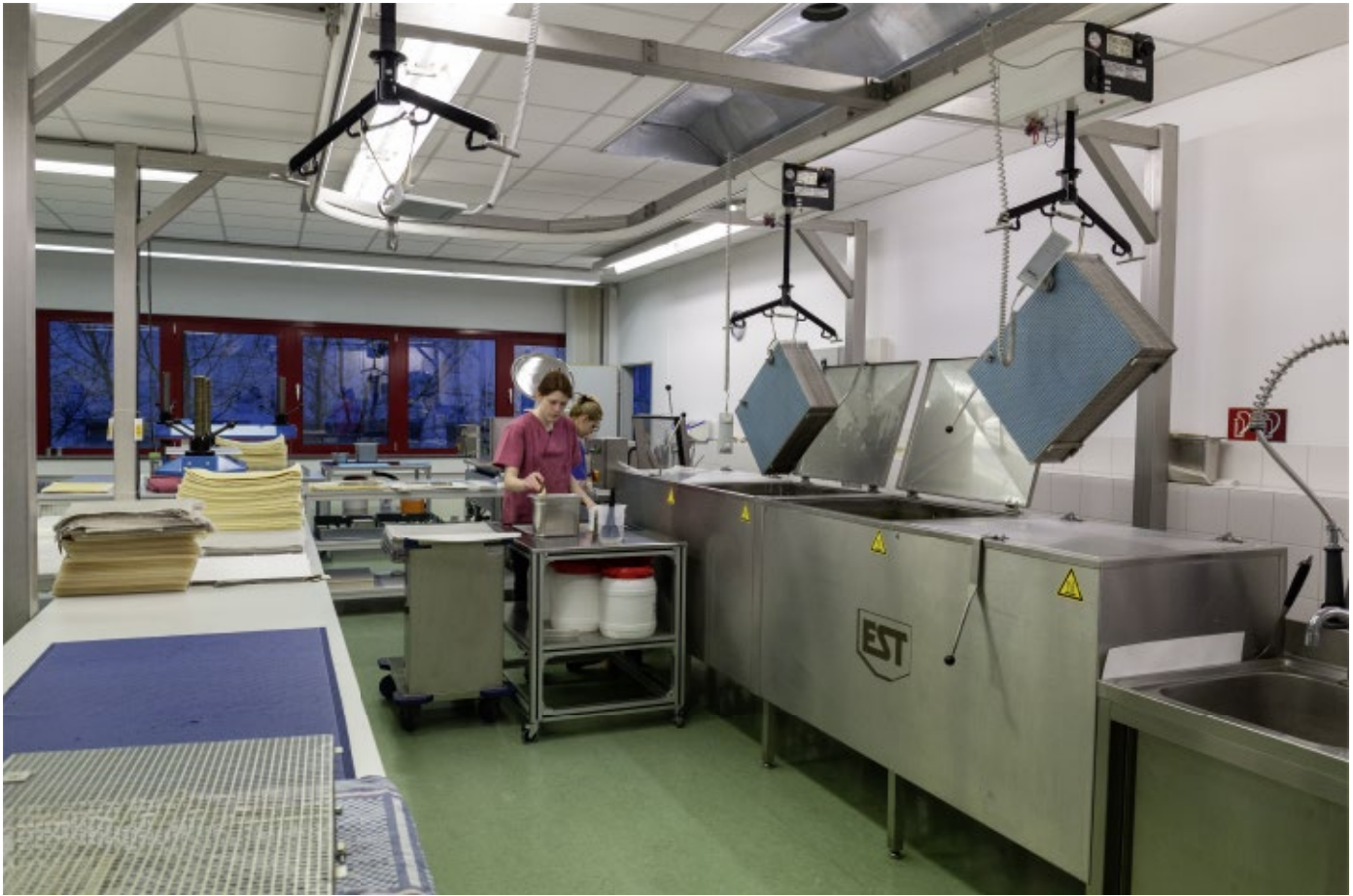
Nassstrecke in der Restaurierungswerkstatt für brandgeschädigtes Schriftgut in Weimar-Legefild
